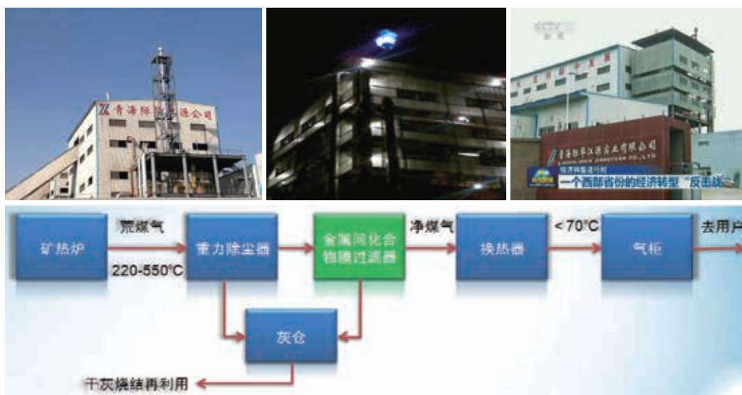
图6 高碳铬铁矿热炉荒煤气高温过滤
