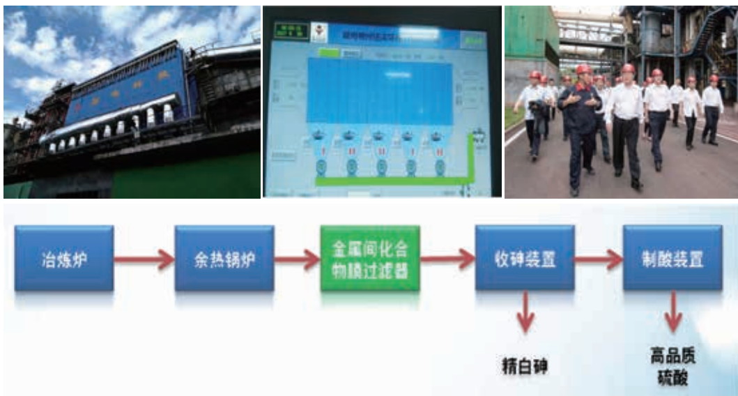
图 10 高温含尘含砷烟气高温除尘及低温回收精白砷
