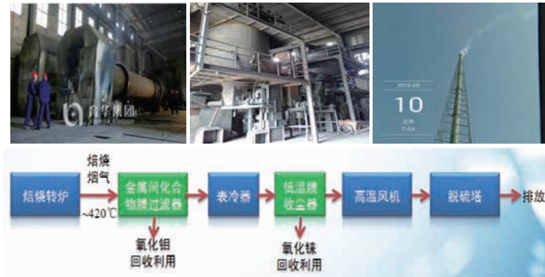
图 8 焙烧烟气高温过滤回收氧化钼粉尘
