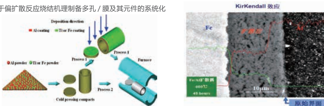
图 1 金属间化合物多孔 / 膜材料制备过程及反应原理
