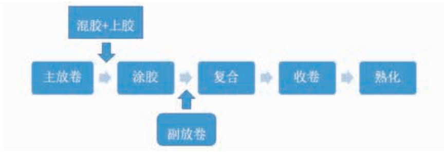
图 2-1 无溶剂复合工艺流程简图
