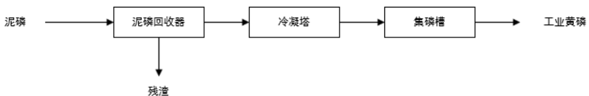
图1 泥磷蒸馏回收元素磷工艺流程图
