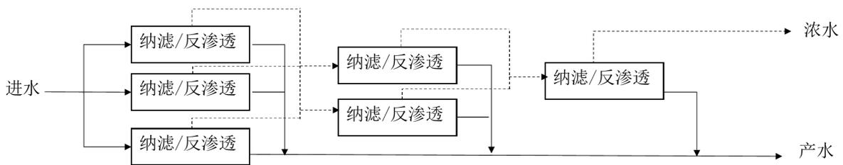
图 2 一级多段处理推荐工艺流程
