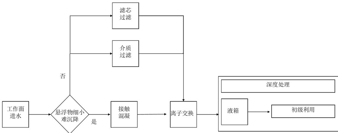
图 C.2 高矿化度进水初级利用基本处理工艺流程
