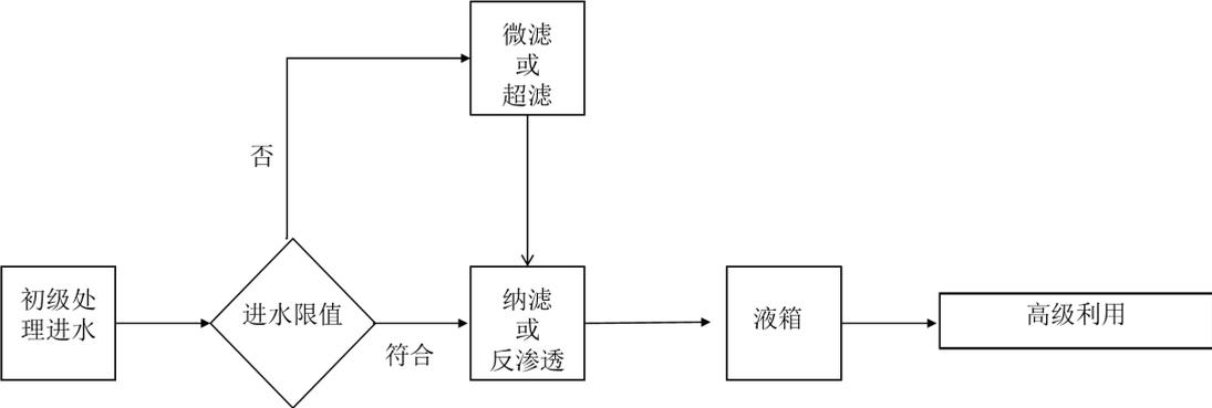
图 C.4 高矿化度进水高级利用基本处理工艺流程
