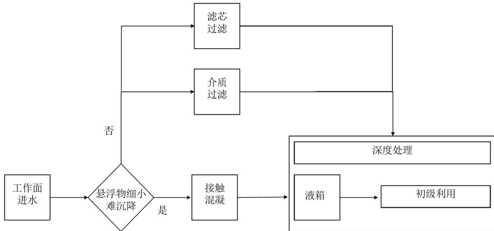
图 C.1 一般进水初级利用基本处理工艺流程
