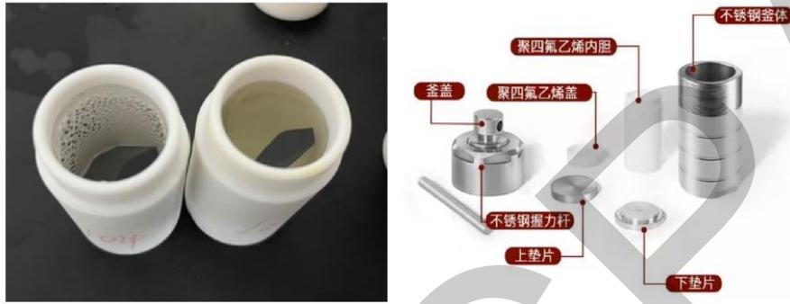
图 J.1  $\text{CO}_2$  吸收液腐蚀性测定反应釜及内衬示意图
