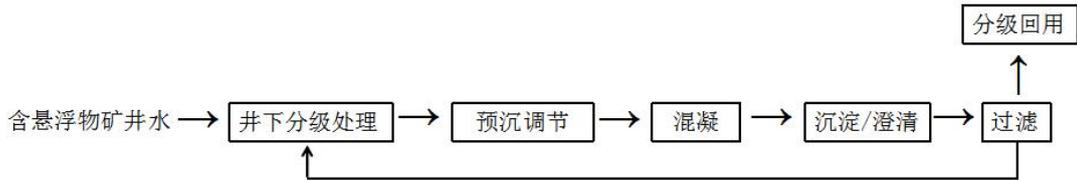
图2 含悬浮物矿井水井下原位处理与回用基本流程图
