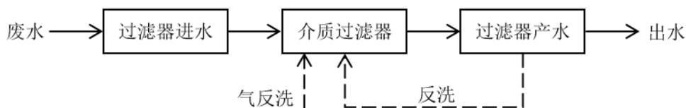
图 3 介质过滤工艺流程
