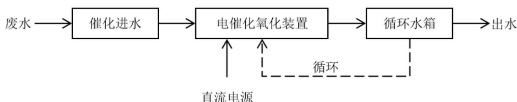
图8 电催化氧化工艺流程
