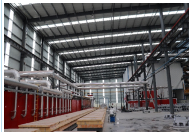
隧道窑排烟管道将余热分送至高铬砖干燥窑及 RH 浸渍管干燥窑
